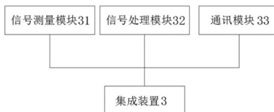
1. 退火炉内钢带位置测量传感器,其特征在于,包括壳体(1)、天线(2)和集成装置(3),所述集成装置(3)包括用于高频电磁波的发射和接收的信号测量模块(31)、用于信号处理的信号处理模块(32)和进行通讯协议的通讯模块(33),所述信号测量模块(31)与天线(2)电性连接。
