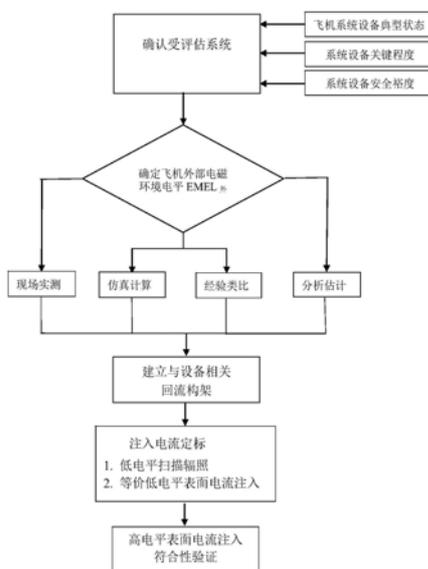
1. 一种飞机电磁环境安全裕度评估规程方法,其特征在于包含适用于飞机外部电磁环境安全裕度评估的高电平表面电流注入法,步骤如下:
