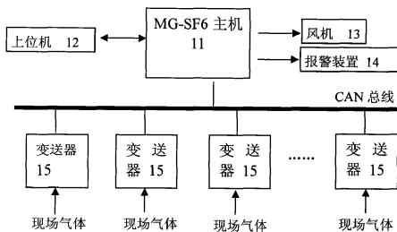
1. 一种六氟化硫气体及其衍生气体监测监控的装置，其特征在于：主要由上位机(12)、风机(13)、报警装置(14)、系统主机(11)及与之相连的多个变送器(15)组成；各变送器(15)通过 CAN 总线分别与系统主机(11)相连，系统主机(11)还分别与上位机(12)、及联动的风机(13)和报警装置(14)相连。
