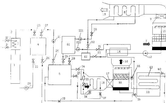
1. 一种太阳能吸收式液体除湿空调系统，其包括太阳能集热器、吸收式制冷机、与所述太阳能集热器形成第一热媒水循环回路的蓄热水箱、与所述吸收式制冷机形成第一冷媒水循环回路的空气冷却器、设置于所述空气冷却器的空气入口前段的除湿器以及与所述除湿器形成除湿溶液循环回路的再生器，其中，所述太阳能吸收式液体除湿空调系统进一步包括通过管道与所述吸收式制冷机以及所述蓄热水箱连通并形成第二热媒水循环回路的加热水箱、以及设置于所述加热水箱内并包括在所述除湿溶液循环回路中的稀溶液加热管道；
