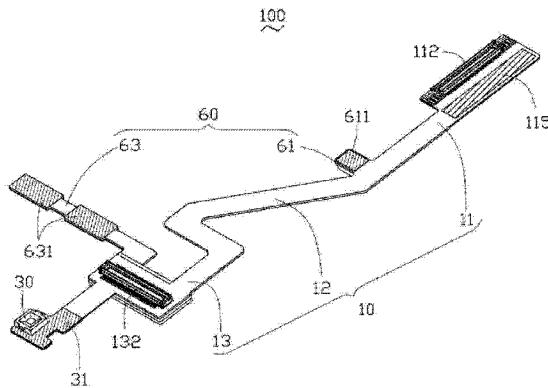
1. 一种柔性印刷线路模组，其包括一主体及至少一连接插座，该主体包括一第一连接端、一带体部及一第二连接端；所述第一连接端与第二连接端分别位于该带体部的两端，且所述第一连接端及第二连接端上分别设置有一第一连接器、第二连接器；该带体部内预设有包括接地线路的若干层线路，所述第一连接器及第二连接器通过设置于带体部内部的线路相互电性连接；所述连接插座电性连接于所述主体的第一连接器和第二连接器中的至少一个；其特征在于：所述连接插座周围涂敷有一导电涂层，该导电涂层与所述接地线路电性连接。
