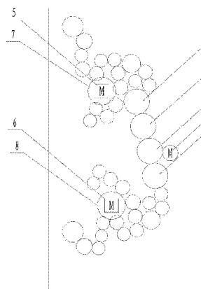
1. 一种印刷机组用驱动装置,包括与所述印刷机组中上水墨组件(7)相连的第一驱动电机(5)和与所述印刷机组中下水墨组件(8)相连的第二驱动电机(6),其特征在于:还包括第三驱动电机(9),所述第三驱动电机(9)的输出端通过依次啮合的传动齿轮组(11)分别与印刷机组中四根印刷滚筒相连。
