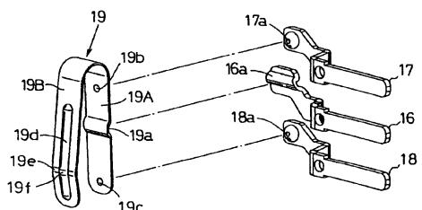
1. 一种开关，设置有在一侧开口的凹形壳体和闭锁该开口面的盖罩，在所述壳体内对设导电性固定接点片和可动接点片，将在所述壳体上保持并进行操作的操作部件的操作力加在所述可动接点片上，通过使该可动接点片的可动变位，在接点部之间进行接离，进行开关操作，其特征在于：
