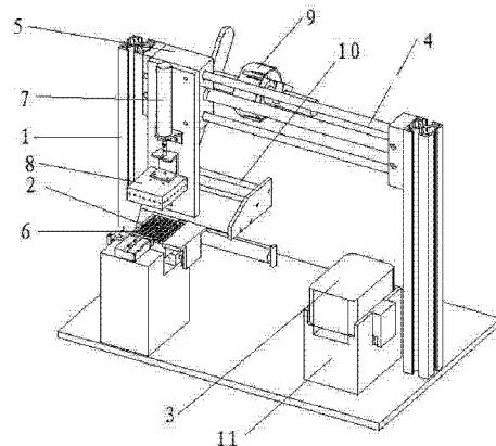
1. 一种自动粘贴标签机,其特征在于包括工作架、吸取机构和传动机构,所述工作架上安装有传动机构,传动机构与吸取机构固定连接,所述工作架下方安置铺放标签的平台和产品外壳。
