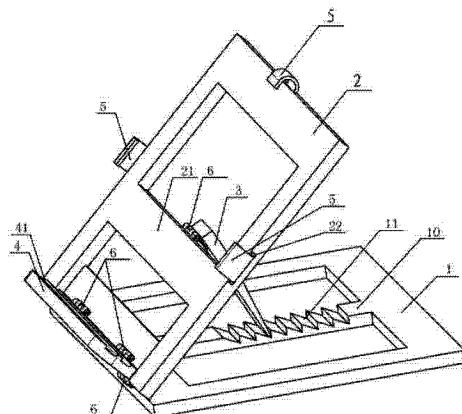
1. 一种多角度平板电脑支架，包括底座(1)、用于放置平板电脑的搁置板(2)，所述底座与搁置板通过铰接件(6)铰接，底座与搁置板之间设置有用于维持搁置板倾斜角度的支撑板(3)，底座上设置有用于调节搁置板倾斜角度的沟槽(11)，其特征在于，所述搁置板与底座铰接的一边设置有托板(4)，托板上设置有若干定位槽(41)，所述搁置板的边缘设置有若干挡板(5)。
