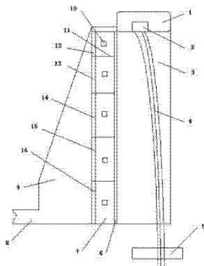
1. 一种用于纺制粗旦纤维的吹风冷却方法,经纺丝组件喷出的丝束进入冷却甬道中,在冷却甬道内冷却空气通过吹风壁吹入冷却甬道,进行丝束的冷却加工,其特征在于:所述的冷却加工分为3~7段进行,每一段的侧吹风温度依次降低3~10℃。
