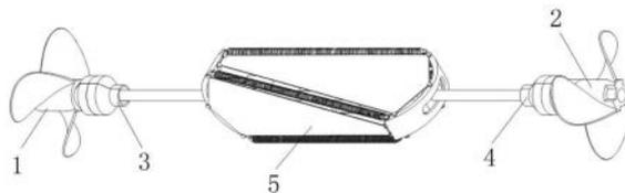
1. 一种超声电机驱动的水下螺旋桨矢量推进系统,其特征在于,包含压电驱动单元、第一驱动件、第二驱动件、第一螺旋桨、第二螺旋桨和转向单元;
