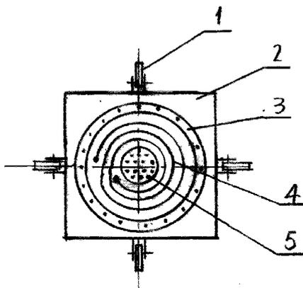
1. 一种气电组合式加热器,包括壳体(2)和电加热元件总成(4),其特征在于在壳体(2)上:①、位于电加热元件总成(4)中心部位处配装燃气内侧燃烧炉头(5);或者②位于电加热元件总成(4)外侧部位处配装燃气外侧燃烧炉头(3);或者③位于电加热元件总成(4)中心部位和外侧部位处同时分别配装燃气内侧燃烧炉头(5)和燃气外侧燃烧炉头(3)。
