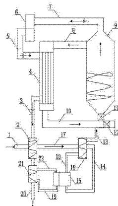
1. 一种混合型蒸汽机械再压缩蒸发器，主要由物料蒸汽压缩机(6)、冷煤压缩机(15)和MVR蒸发器(9)及三个换热器组成；其中，蒸汽压缩机(6)把在MVR蒸发器(9)中物料蒸发出产生的二次蒸气，通过蒸汽压缩机进汽管(7)引给蒸汽压缩机(6)压缩，二次蒸气经压缩升温后通过蒸汽压缩机出汽管(5)为四号换热器(4)提供热源；物料通过上输料管(8)经四号换热器(4)再加热后，又通过下输料管(10)回到MVR蒸发器(9)内，构成循环蒸发浓缩，维持蒸发系统正常运行；四号换热器(4)中的二次蒸气液化成液体后，通过四号排冷凝液管(3)输给一号换热器(2)和三号换热器(21)，冷凝液从三号排液管(20)排出；冷煤压缩机(15)通过冷煤吸热管(22)和冷煤吸热返回管(19)与三号换热器(21)连接，吸收三号换热器(21)排出冷凝液的余热能，并将得到的热能经冷煤压缩机(15)压缩升温后，通过冷煤放热输出管(14)和冷煤放热返回管(18)将热能输给第二换热器(16)，在第二换热器(16)中对刚进入的鲜物料预热。
