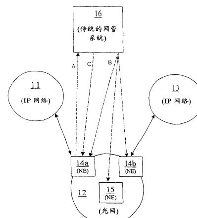
1. 一种操作面向连接的通信网络(12:22)的方法，所述面向连接的通信网络(12:22)包括多个网元(15)，其中经过所述网元的连接由网管系统(16:26)建立；所述面向连接的通信网络(12:22)可通过边缘网元(14a:24a)连接到第一通信网络(11:21a)，所述第一通信网络包括多个网元，各个网元能够根据所述网元接收的连接请求在所述第一通信网络上进行连接或对数据进行路由；所述连接请求符合预定协议，所述方法用于响应来自所述第一通信网络的连接请求而建立经过所述面向连接的通信网络(12:22)的连接，其特征在于：所述边缘网元(14a:24a)从所述第一通信网络收到连接请求时，向所述网管系统(16:26)发送有关所述连接请求的信息；所述网管系统(16:26)发送信号，以便响应从所述边缘网元接收的所述信息而设置通过所述面向连接的通信网络的连接；以及所述网管系统使所述边缘网元(14a:24a)向所述第一通信网络发送符合所述预定协议的返回信号，表明连接设置状态。
