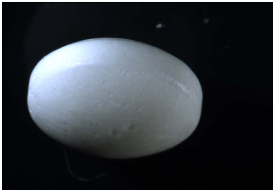
Núcleo de comprimido tratado térmicamente @ 55C durante 30 mins
