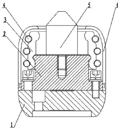
1. 一种大电流开关用导电触座,包括梅花触头、触头座和屏蔽罩,梅花触头设置在触头座上部,屏蔽罩设置在梅花触头的外侧,其特征是:还包括中间触座,所述的中间触座为圆柱形,通过螺栓设置在触头座上部,中间触座的上部边缘设置有凸缘,中间触座的上部中心处设置有螺纹孔;梅花触头由若干个触指形状的触片和拉簧组成,所述的触片围成环形柱体结构,在触片组成的环形柱体的外环壁上设置有安装拉簧的凹槽,拉簧套为三个,上下分布并套设在触片组成的环形柱体的外侧,所述的触片为紫铜材质,触片的外表面设置有镀银层,在梅花触头内环壁上设置有与中间触座的凸缘相匹配的凹槽,梅花触头设置在中间触座上部外侧;在中间触座上部设置有导向棒,导向棒上端呈圆锥形,其下端通过螺杆与中间触座连接。
