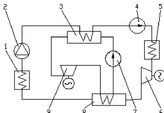
1. 一种低温朗肯双循环发电装置,包括吸热器、压缩机、冷凝器、工质泵、蒸发器、膨胀发电机组、第二膨胀发电机组、换热器、第二工质泵,它还包括系统内相连接的管道、附件及检测和控制装置,它有两条封闭循环发电系统,密闭系统内有工质,其特征是:吸热器、压缩机、冷凝器、工质泵、蒸发器、膨胀发电机组、换热器依次连接形成第一封闭循环发电系统,冷凝器、第二膨胀发电机组、换热器、第二工质泵依次连接形成第二封闭循环发电系统。
