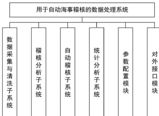
1. 一种用于自动海事稽核的数据处理系统,其特征在于,包括数据采集与清洗子系统、稽核分析子系统、自动稽核子系统、统计分析子系统、参数配置模块和对外接口模块,其中:
