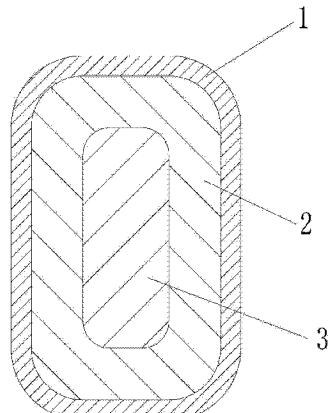
1. 一种变压器线圈用的导线,它包括有导体以及包裹着该导体的绝缘层(1),其特征在于:所述导体为内外层结构,其外层(2)包裹着内层(3),其中,该导体的外层(2)为铜包层,其内层(3)为铝芯或硬质塑胶。
