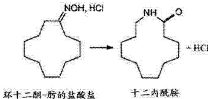
出人意料地,由于精确控制温度和停留时间用于贝克曼重排作用 / 脱氯作用步骤的微型反应器的使用令人惊奇地可以改善脱氯作用的产率和贝克曼重排作用本身的产率,其可以显著地降低副反应 (肟盐酸盐和内酰胺的水解)。
