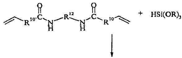
[0181] 向配有温度探针、电搅拌器和冷凝器的 1000ml 三颈圆底烧瓶中引入 50g 实施例 1 的聚醚 - 酰胺和 50g 甲苯，并在 115℃下加热 15 分钟，以溶解聚醚 - 酰胺。然后，借助滴液漏斗逐滴添加 154g 具有下述平均式的二甲基氢封端的聚二甲基硅氧烷：
