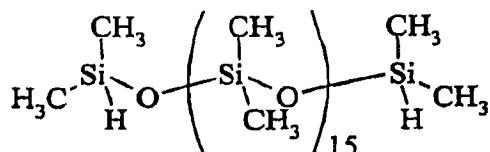
[0183] 在添加头 5g 硅氧烷之后，将 0.28g 铂催化剂（在二甲基硅氧烷内的 1,3- 二乙烯基 -1,1,3,3- 四甲基二硅氧烷铂络合物）加入到该混合物中。当硅氧烷的添加完成时，添加进一步的 0.2g 催化剂，并混合额外 1 小时。然后加热反应混合物到 120℃ 并缓慢地施加真空，以降低压力到低于 10mmHg，以便除去溶剂。所得聚合物的 Mw 为 58300 和多分散性为 3.75。熔融温度为 40.5℃。
