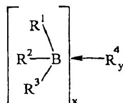
[0025] 在该式中,下标 x 大于或等于 1,下标 y 大于或等于 1,B 表示硼;R<sup>1</sup>、R<sup>2</sup> 和 R<sup>3</sup> 是可独立地选自下述的基团:氢;环烷基;在主链上具有 1-12 个碳原子的直链或支化烷基;烷芳基;有机基硅烷基,例如烷基硅烷或芳基硅烷基;有机基硅氧烷基;能起到与另一硼原子的共价桥作用的亚烷基;能起到与另一硼原子的共价桥作用的二价有机基硅氧烷基;或其取代的类似物。术语“类似物”是指具有结构上类似的核但具有不同化学部分的化合物。R<sup>1</sup>、R<sup>2</sup> 或 R<sup>3</sup> 中的至少一个可任选地含有一个或多个硅原子,且含硅基团共价键合到硼上。R<sup>4</sup> 是
