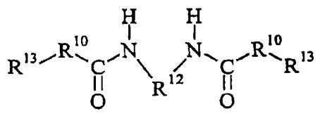
[0076] 其中 R<sup>10</sup> 和 R<sup>12</sup> 如上所述, 和 R<sup>13</sup> 是单价封端基团。R<sup>13</sup> 可以是反应性或非反应性基团。针对 R<sup>13</sup> 的反应性基团例举含诸如下述的官能团的基团 : 羟基 ; 可水解部分, 例如烷氧基, 如甲氧基、乙氧基化和丁氧基 ; 氢化物 ; 不饱和基团, 例如乙烯基 ; 和异氰酸酯基团。反应性基团可以是自由基反应性基团, 例如双键或缩合可固化的基团, 例如烷氧基硅烷或异氰酸酯基团。在式 (III) 中, 每一 R<sup>10</sup> 可以是 2-30 或者 2-12 个碳原子的二价直链烃基。在式 (III) 中, R<sup>12</sup> 可以是聚醚、聚氨酯、硅氧烷例如聚二甲基硅氧烷、聚二苯基硅氧烷、聚甲基
