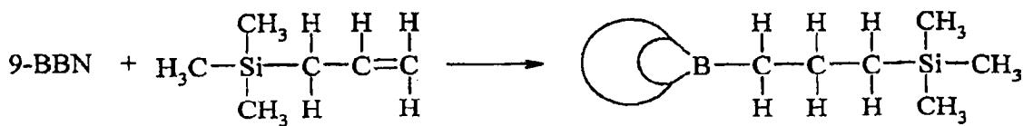
[0058] 以下示出了形成催化剂络合物可使用的一种有机基硅官能的硼烷化合物的另一实例。在这一种中, 硼通过至少两个共价键桥键合到有机基聚硅氧烷上。在有机基聚硅氧烷主链中, 硼原子可在末端或侧基位置处连接:
