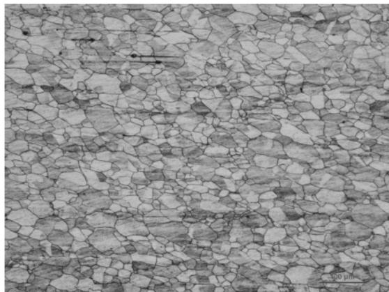
1. 一种刻蚀液在镍材刻蚀中的应用,其特征在於,所述刻蚀液按照质量份计,包括三氯化铁1-3份、磷酸8-26份、浓硝酸6-30份和浓盐酸15-55份;所述镍材为纯镍材。
