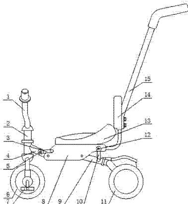
1. 一种折叠三轮车,包括前叉、车架和鞍座,前叉下端设置有前轮,前叉上端设置有能够控制前轮转向的车把,前轮上设置有供折叠三轮车使用者脚踩从而控制折叠三轮车行驶的脚踏驱动装置,车架前端与前叉固定连接,鞍座设置于车架上,车架后方两侧设置有后轮,其特征在于:所诉车架包括连接管、鞍座支架和后车架,连接管的后端部与鞍座支架的前端部之间为活动连接,鞍座支架后端部与后车架前端部之间为活动连接;鞍座与鞍座支架固定连接,鞍座后方设置有靠背且与鞍座支架固定连接,鞍座和靠背均位于后车架上方。
