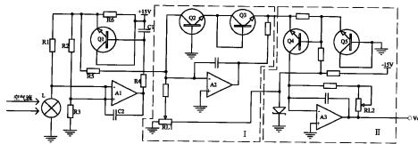
1. 一种测热式风速计，其特征在于：包括由一个正温度系数的加热电阻丝和三个电阻构成的电桥，所述电桥的输出连接到一个差动放大器的输入端，所述差动放大器的输出返回到所述电桥的输入端，还同时顺次连接有零点调节电路和满刻度调节电路。
