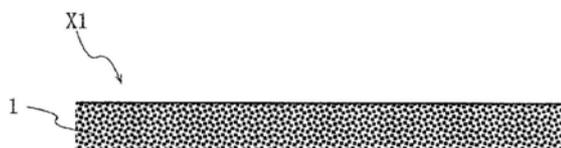
1. 粘合剂组合物,其包含聚合物和离子液体,其中,利用由所述粘合剂组合物所含的成分中的所述离子液体以外的成分形成的组合物来形成粘合剂层、并将该粘合剂层在22℃、20%RH的环境下放置3天后的、该粘合剂层在频率100Hz时的相对介电常数为5以上。
