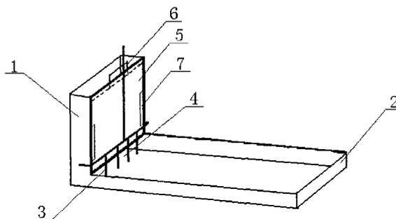
1. 一种自密实混凝土工作性能测量仪,包括竖向立筒(1)、水平槽(2)、钢筋网(3)、出料口(4)、活动拉门(5)、拉手(6)和凹槽(7),其特征在于:竖向立筒(1)和水平槽(2)焊接为一体结构,竖向立筒(1)底部设有出料口(4),竖向立筒(1)外侧设有凹槽(7),活动拉门(5)通过凹槽(7)与竖向立筒(1)连接,活动拉门(5)上设有拉手(6),钢筋网(3)与竖向立筒(1)连接。
