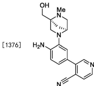
[1377] 将3-(3-((1S,4S)-4-(羟甲基)-5-甲基-2,5-二氮杂双环[2.2.1]庚-2-基)-4-硝基苯基)异烟腈(26mg,0.071mmol)、铁(20.0mg,0.356mmol)和氯化铵(22.9mg,0.427mmol)在THF(1mL)、H<sub>2</sub>O(1mL)和甲醇(1mL)中的混合物在60 $^{\circ}$ C下搅拌1小时。冷却到室温后,将其通过硅藻土塞过滤,并用CH<sub>2</sub>Cl<sub>2</sub>稀释。将有机相分离,用盐水洗涤,经MgSO<sub>4</sub>干燥,过滤并真空蒸发溶剂。得到的粗产物不经进一步纯化用于下一步。 $C_{19}H_{22}N_5O$  (M+H) $^{+}$ 的LCMS计算值:m/z=336.2;实测值:336.2。
