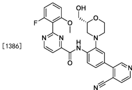
[1387] 以类似于实施例51步骤1-3的方式,以(R)-吗啉-2-基甲醇代替(2R,5S)-5-(羟甲基)-2-甲基哌嗪-1-甲酸叔丁酯作为起始物质来制备此化合物。C<sub>29</sub>H<sub>26</sub>FN<sub>6</sub>O<sub>4</sub> (M+H)<sup>+</sup>的LCMS计算值:m/z=541.2;实测值:541.3。
