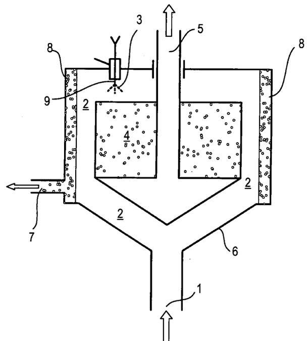
(57) Hauptanspruch: Gasturbinenölabscheider mit einem Gehäuse (6), welches mit einem Einlass (1) versehen ist, wobei in dem Gehäuse (6) ein in Rotation versetzbare Filterelement (4) angeordnet ist, welches mit einem Luftablass (5) stromab des Filterelements (4) versehen ist, wobei das Gehäuse (6) zumindest einen Ölabblass (7) umfasst, dadurch gekennzeichnet, dass stromauf des Filterelements (4) Mittel (3) zur Aufbringung von elektrostatischen Kräften angeordnet sind.
