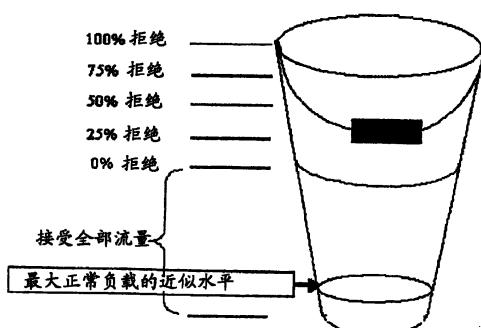
1. 一种业务处理系统 (SCP)，包含漏桶和流量控制装置，所述流量控制装置用来监控每个业务的反应时间，并将每个反应时间和预定反应时间相比较，其中对不同的业务采用所述预定反应时间的至少两个不同值，并且当一个业务的反应时间超过与特定业务对应的预定反应时间时，则增加漏桶内的内容，且所述流量控制装置设计为监视漏桶的内容，并且在一固定值以上按照漏桶的内容成比例地拒绝业务，而在该固定值以下不拒绝任何流量。
