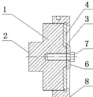
1. 一种用于车削复杂型面钛合金薄壁件的专用夹具,其组成包括:胎具,其特征是:所述的胎具的一侧具有与机床连接的大凸台,所述的胎具的另一侧具有与工件连接的小凸台,所述的小凸台通过螺纹与外轮廓紧固圈连接。
