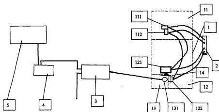
1. 飞行器二自由度稳像云台，包括一个检测装置，一个动作装置和一个图像采集装置，其特征是：所述检测装置与所述动作装置电连接，所述动作装置与图像采集装置固定连接，所述检测装置用于检测飞行器的摆动角度，所述动作装置用于对检测装置的检测结果作相应的调整动作。
