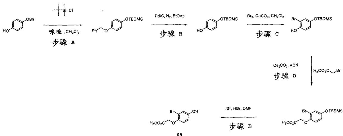
步骤 A: 将 4-苄氧基-苯酚(5.01g, 25.0mmol)混悬在 65mL 二氯甲烷中。加入固体咪唑(4.05g, 26.9mmol), 继续搅拌直至混合物变均匀。分批加入叔丁基-氯-二甲基-硅烷(2.49g, 36.6mmol), 有白色沉淀开始生成。将混悬液于室温搅拌过夜。然后过滤, 浓缩, 得到(4-苄氧基-苯氧基)-叔丁基-二甲基-硅烷, 为白色粉末:
