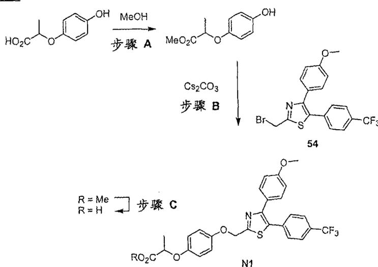
步骤 A: 将 2-(4-羟基-苯氧基)-丙酸(25mg, 0.14mmol)溶于 MeOH (20mL)。加入噻吩基氯(5 $\mu$ L, 0.06mmol)，将溶液在 60 $^{\circ}$ C 下搅拌 2 小时。在真空下除去溶剂，得到粗的 2-(4-羟基-苯氧基)-丙酸甲酯，为白色固体：
