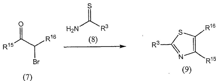
其中  $p$ 、 $R^{13}$ 、 $R^{17}$  和  $L^2$  如发明概述中式 I 所定义； $R^{15}$  和  $R^{16}$  独立地选自氢、烷基或任意环状基团(环烷基、杂环烷基、芳基和杂芳基，如发明概述中所定义)。任选在溶剂(例如乙醇等)的存在下，使式 7 化合物与式 8 化合物反应，制备式 9 化合物。该反应在约  $10$  至约  $200^\circ\text{C}$  的温度范围内进行，历时约 30 小时完成。
