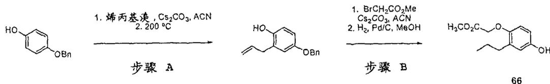
步骤 A: 将 4-苄氧基-苯酚(5.0g, 25mmol)溶于乙腈(70mL)。加入粉末状碳酸铯(10.50g, 32.2mmol), 同时搅拌, 继之以烯丙基溴(2.25mL, 26.6mmol)。将混合物剧烈搅拌过夜。通过硅藻土 545 塞过滤, 将固体用更多的乙腈洗涤, 溶液经 Na<sub>2</sub>SO<sub>4</sub> 干燥, 浓缩, 得到烯丙基醚, 为白色固体。在密封的小瓶中将该醚(1.83g, 7.62mmol)在氮气下加热至 200°C。约 4.5 小时后, 将混合物冷却, 得到浅褐色油:
