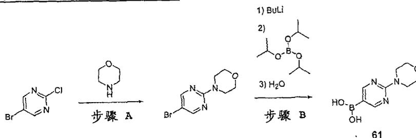
步骤 A: 将吗啉(5.4mL, 62.4mmol)溶于 MeCN (250mL)。加入  $\text{K}_2\text{CO}_3$  (8.6g, 62.4mmol)，将混合物于室温搅拌 1 小时。然后加入 2-氯-5-溴嘧啶
