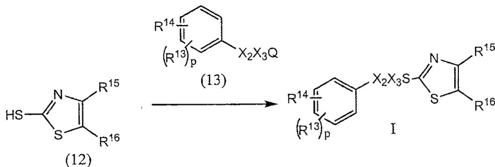
其中  $p$ 、 $R^{13}$ 、 $R^{14}$ 、 $R^{15}$  和  $R^{16}$  如发明概述中式 I 中所定义； $X_2$  是 S 或 O； $X_3$  是价键或 C<sub>1-4</sub> 亚烷基；Q 是卤代基，优选 Br 或 Cl。在适宜的溶剂(例如乙腈、乙醇等)的存在下，使式 10 化合物与式 11 化合物或者使式 12 化合物与式 13 化合物反应，制备式 I 化合物。该反应在约 10 至约 80°C 的温度范围内进行，历时约 24 小时完成。
