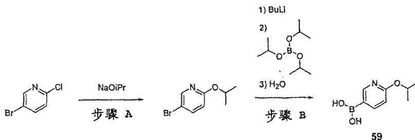
步骤 A: 将 NaH (5.2g, 130mmol) 混悬在异丙醇(50mL)中。将混合物在  $60^\circ C$  下搅拌 30 分钟。气体放出停止后, 加入 2-氯-5-溴吡啶(10.0g, 52mmol) 的异丙醇(100mL) 溶液, 将混合物于回流加热 24 小时。真空除去溶剂, 将剩余物溶于  $H_2O$ , 用 EtOAc 萃取。分离有机层, 经  $MgSO_4$  干燥,
