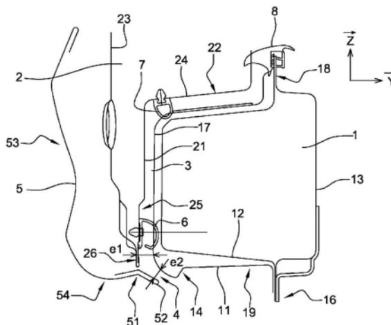
1. 一种保护元件(5),该保护元件用于旨在以铰接方式安装在机动车辆的车身结构上的开口叶片,该保护元件包括:主壁(53),该主壁旨在覆盖车门外面板(23),该保护元件以可逆方式安装在该车门外面板上;以及下端壁(54),该下端壁具有自由倾斜边缘(52),该自由倾斜边缘被设计成在该车身结构下方延伸、以便与该车身结构形成用于车门下部区域(25)的保护屏障,该车门下部区域包含用于防止石屑的密封元件(6),
