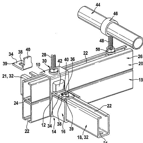
Изобретение касается узлового соединителя для закрепления монтажной шины встык с другой монтажной шиной с признаками ограничительной части пункта 1 формулы изобретения.
