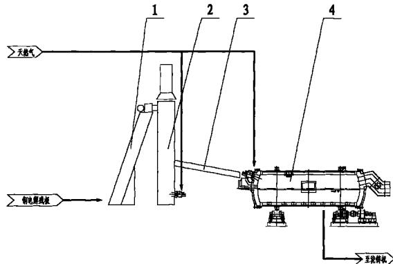
1. 一种铜电解残极处理设备,包括竖炉及保温回转炉,其特征在于 :
