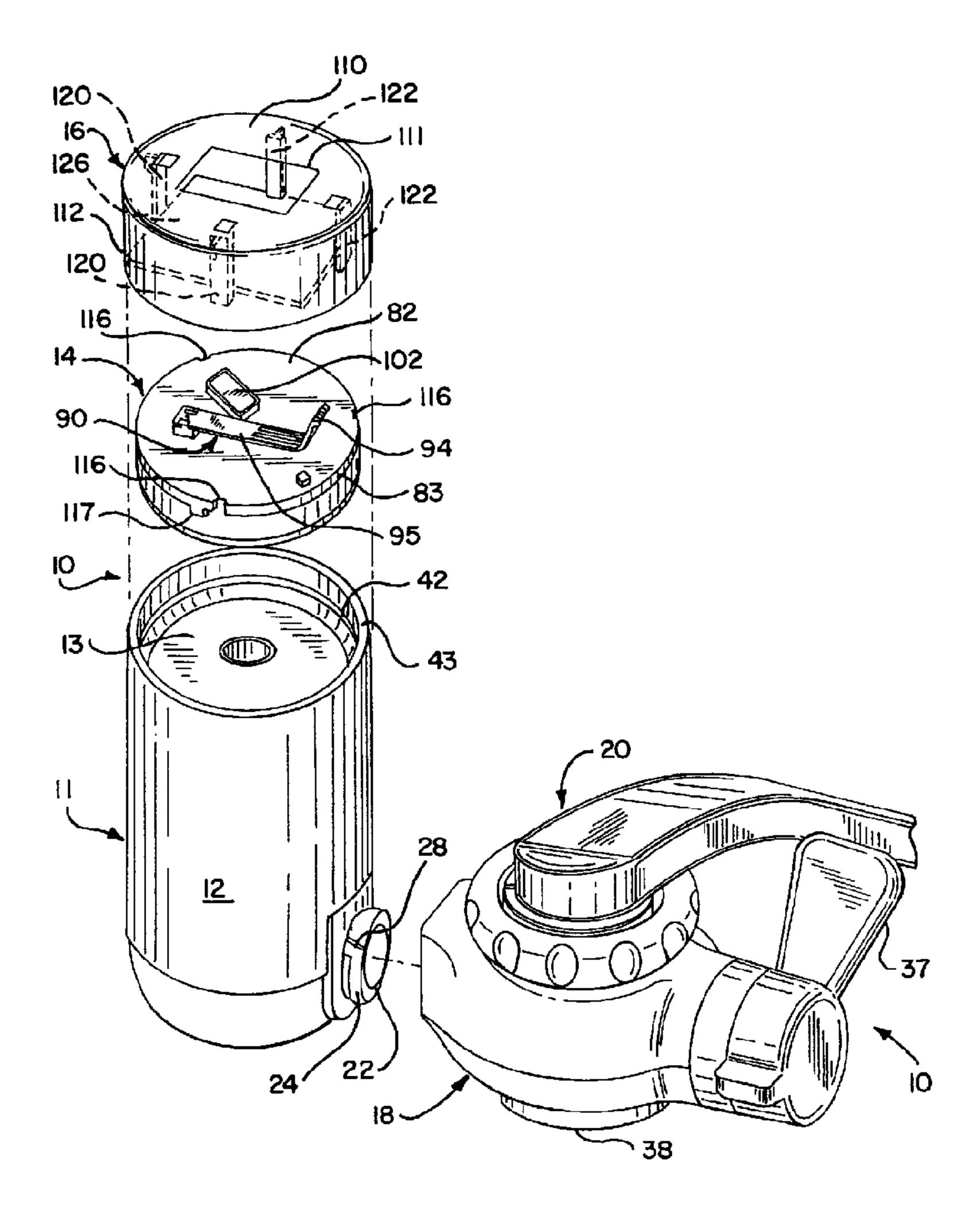
(57) La présente invention a pour objet un dispositif de filtration d'eau avec dispositif de contrôle du débit pour montage sur un robinet; le filtre en question est logé dans un boîtier doté d'un couvercle flexible dont la déformation permet à l'eau de s'introduire dans le boîtier. La déformation du couvercle produit la fermeture
