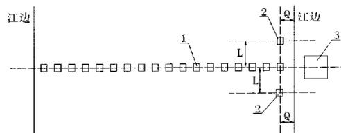
1、一种隧道过江施工中用于监测河床沉降的装置，其特征在于包括由至少二个沉入江底固定的水压传感装置(1)组成的水压传感采集机构及设置于江边的信号接收处理分析装置(3)，其中，所述信号接收处理分析装置(3)包括用于接收各水压传感装置(1)产生的振动信号的信号接收仪及装有数据处理及分析系统的电子处理装置，所述各水压传感装置(1)分别通过数据线与信号接收仪相连接，所述信号接收仪通过数据线与电子处理装置的相连接并通过电子处理装置对水压传感装置(1)产生的信号进行实时处理分析而得到河床沉降的监测数据。
