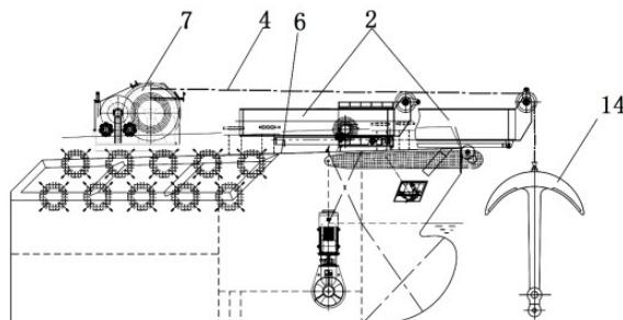
1.一种拖轮用伸缩式起抛锚装置,其特征在于:包括座体、水平可伸缩起锚架、铰轴连接式液压油缸、起锚绳以及导链滚轮,其中:
