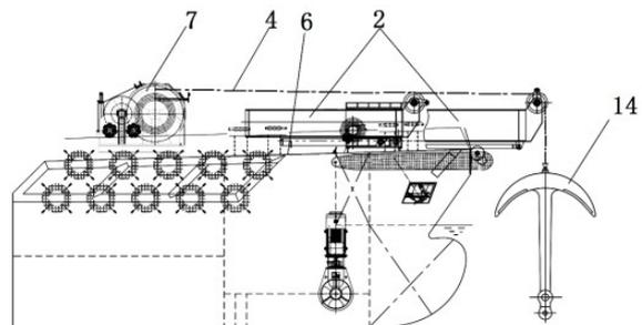
1. 一种拖轮用伸缩式起抛锚装置,其特征在于:包括座体、水平可伸缩起锚架、铰轴连接式液压油缸、起锚绳以及导链滚轮,其中:
