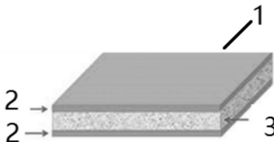
1. 一种铁电聚合物基电介质薄膜,其特征在于,所述薄膜具有至少一个第一电介质层和与所述第一电介质层交替层叠的第二电介质层,
