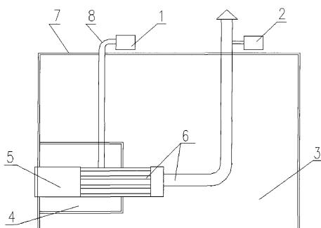
1、一种燃煤直热式沥青加热罐，包括罐体和加热炉，其特征在于：
