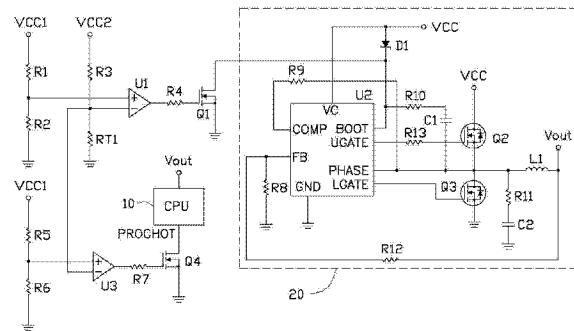
1. 一种芯片保护电路,包括一为芯片提供工作电压的供电电路、一第一比较器、一第一电阻、一热敏电阻及一第一电子开关,该第一比较器的正向输入端与一第一电源相连,该第一比较器的反向输入端通过该第一电阻与一第二电源相连,该第一比较器的反向输入端还通过该热敏电阻接地,该第一比较器的输出端与该第一电子开关的第一端相连,该第一电子开关的第二端接地,该第一电子开关的第三端与该芯片的热保护引脚相连;当该第一电子开关的第一端为高电平时,该第一电子开关的第二端与第三端导通;当该第一电子开关的第一端为低电平时,该第一电子开关的第二端与第三端截止;当该芯片的温度不高于第一温度值时,该第一比较器的反向输入端的电压大于其正向输入端的电压,该第一比较器的输出端输出低电平的控制信号,该第一电子开关的第二端与第三端截止;当该芯片的温度达到第一温度值时,该第一比较器的反向输入端的电压小于其正向输入端的电压,该第一比较器的输出端输出高电平的控制信号,该第一电子开关的第二端与第三端导通,该热保护引脚为低电平,该芯片进入降频工作模式。
