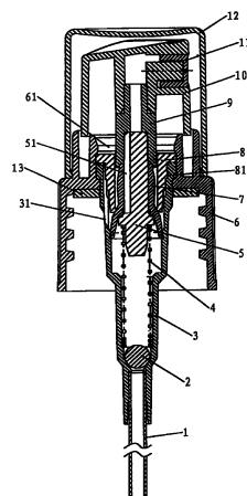
1、一种喷雾泵，包括泵体、活塞、弹簧、螺盖、玻珠、按头和扩散嘴，其中玻珠与泵体内腔的下开口构成吸液单向阀，扩散嘴安装在按头上，活塞位于泵体内腔，其特征在于泵体上开口固定在螺盖中，活塞的连接柄伸出泵体外与按头固定，活塞的轴向通孔连通泵体内腔与扩散嘴，活塞内侧放置封住活塞轴抽通孔下开口的开关块，开关块与泵体内腔底部之间放置所述弹簧，开关块上部设有伸入活塞的轴向通孔内的柱，该柱的外径与活塞的轴向通孔滑动配合且在柱的表面沿轴向开有侧槽。
