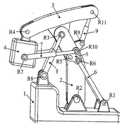
1. 一种含有复合铰链的三自由度多功能连杆工作装置,其特征在于:机架(1)上设有三对对称的基座,其中机架(1)中部的一对基座通过铰链与大臂(2)的一端连接,该大臂(2)的另一端与大臂油缸(8)的活塞杆端部以及小臂(3)中部通过铰链连接构成复合铰链,该大臂油缸(8)的缸套端部通过铰链与机架(1)上一端的一对基座连接;上述小臂(3)的一端通过铰链与一个小臂油缸(9)的活塞杆端部连接,该小臂油缸(9)的缸套端部通过铰链与上述大臂(2)上部连接;上述小臂(3)的另一端通过铰链与末端执行器(4)的一个部位连接;一对末端执行器油缸(7)的缸套端部通过铰链与上述末端执行器(4)的另一部位连接;该末端执行器油缸(7)的活塞杆端部通过铰链分别与一对摇杆(5)连接,该摇杆(5)通过铰链连接在上述大臂(2)的中部;上述摇杆(5)还分别通过铰链与一对拉杆(6)的一端连接,该拉杆(6)的另一端分别与机架(1)另一端的一个基座连接;上述摇杆(5)上的三个铰链呈三角形布置。
