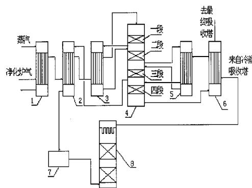
1. 一种湿气体转化及热回收制酸工艺，是硫酸生产工艺的改进，其特征在于取消了干燥塔及相应干燥酸循环系统和冷却水循环系统，采用耐二氧化硫气体腐蚀的换热器，将净化后的含水湿炉气加热到露点以上，然后再进入钢制换热器继续加热到 400℃以上，达到 SO<sub>2</sub> 转化工艺要求的温度。
