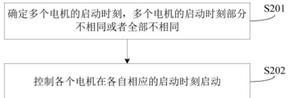
1. 一种电机控制方法,应用于激光雷达,所述激光雷达包括多个电机,其特征在于,包括:
