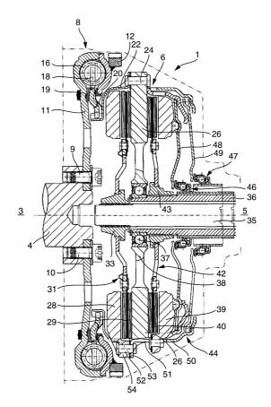
(57) Zusammenfassung: Reibungskupplung mit wenigstens einem Kupplungsgehäuse, zumindest einer mit diesem drehfest, jedoch begrenzt axial verlagerbar verbundenen Anpressplatte sowie zwischen dem Kupplungsgehäuse und der Anpressplatte wirksamen Betätigungsmitteln zur axialen Kraftbeaufschlagung der Anpressplatte.
