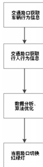
1. 一种智能调节交通灯时间的方法,其特征是,以每个交通路口为节点,在每个交通路口设置摄像装置、控制系统,通过摄像装置取得交通路口机动车道路上的车辆行驶信息,包括车辆行驶方向、各行驶方向的机动车数量,通过摄像装置取得交通路口人行道上的行人信息,包括行人数量、行人远离或靠近路口状态,所述的摄像装置将车辆行驶信息、行人信息传送给控制系统,所述的控制系统对车辆行人的行为数据进行分析,得到最优红绿灯切换策略;
