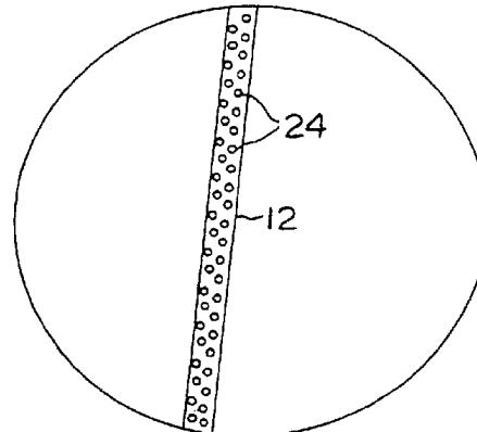
1. 一种用于制造例如纸杯的纸板容器的纸板材料，该材料包括纸板幅，该纸板幅包括木质纤维和已分散在该纤维中的已膨胀微球，其表观密度为约  $0.38 \sim 0.64\text{g/cm}^3$ ，其厚度约为  $610 \sim 889\mu\text{m}$ ，而其内部结合强度至少约为  $168 \times 10^{-3}\text{kJ/m}^2$ 。
