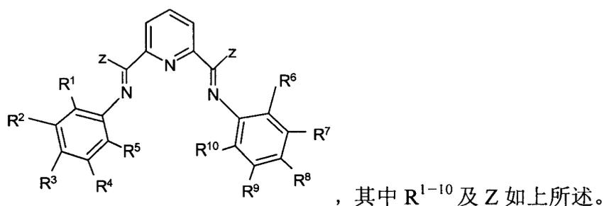
所述的芳基吡啶基双亚胺的一种合成方法可以由 2, 6-吡啶二酮与苯胺衍生物，在有机溶剂中，如  $C_{5-8}$  的烷烃、甲苯、苯、二甲苯、乙醚、甲醇、或乙醇等中，用铝化合物、或铝化合物和硅化合物的复合物作催化剂，反应 1-50 小时，生成芳基吡啶基双亚胺配体。反应中可加吸水剂。其中 2, 6-吡啶二酮、苯胺衍生物或萘胺衍生物、催化剂和吸水剂四者的摩尔比为 1: 1-5: 0.005-10: 0-100，以 1: 2-4: 0.01-0.1: 2-10 为好。所述的铝化合物是氧化铝、卤化铝、氢氧化铝。铝化合物和硅化合物的复合物是铝硅酸盐，或其它氧化铝、卤化铝、氢氧化
