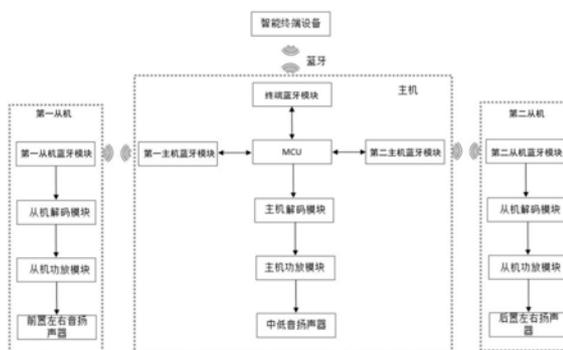
1. 一种同音源无线多声道播放的音响设备,其特征在于:该音响设备包括一个主机和若干个从机,所述主机设有MCU、终端蓝牙模块、主机蓝牙模块、主机解码模块、主机功放模块、中低音扬声器,所述MCU分别与所述终端蓝牙模块、所述主机蓝牙模块、所述主机解码模块连接,所述主机解码模块、所述主机功放模块、所述中低音扬声器依次连接,所述终端蓝牙模块用于与智能终端设备无线连接,所述主机蓝牙模块的数量与所述从机的数量相匹配;
